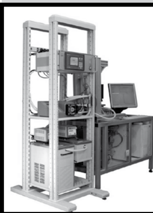
RYS. 2. Widok ogólny symulatora żucia. FIG. 2. View of mastication simulator.
