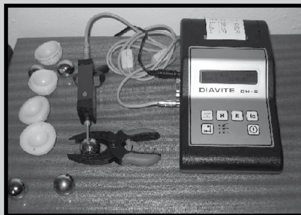
RYS. 2. Urządzenie do pomiaru chropowatości DIAVITE DH – 5. FIG. 2. DIAVITE DH – 5 device for measurements of roughness.
