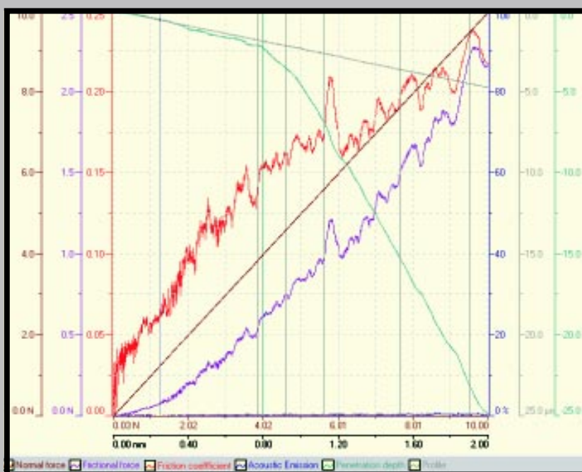
RYS. 13. Wyniki testu zarysowania powłoki wykonane na próbce z tytanu pokrytej powłoką diamentopodobną [3].
