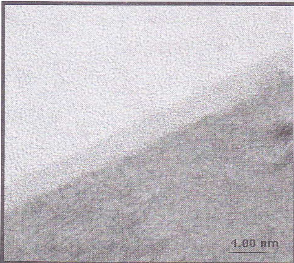
RYS. 1. Wysokorozdzielczy obraz mikroskopowy warstwy amorficznego tlenku. FIG. 1. HREM image of the amorphous oxide.
